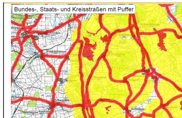
Zunächst bestimmt man die sog. harten Tabuzonen, das sind Flächen, an denen aus baurechtlicher Sicht kein Windrad stehen kann, also z.B. in der näheren Umgebung von Straßen und Trassen (Bild rechts), Radaranlagen oder Flugplätzen, oder in Schutzgebieten (Bild links). Diese Flächen (in den Karten rot oder gelb markiert) fallen schon mal aus der Betrachtung.
