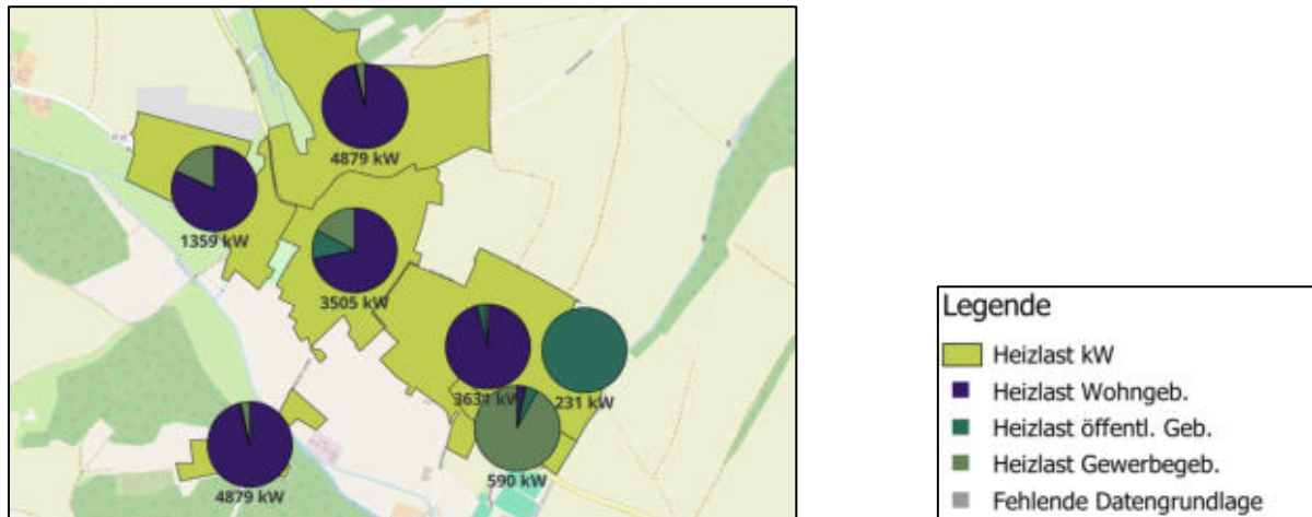
Abbildung 43: Heizlast in [kW]
